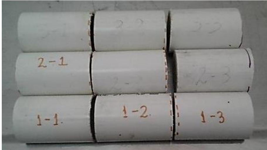
Figura 15. Plugs construidos por el operador A.
