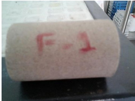
Figura 23. Plug sintético antes de la prueba de desplazamiento con vapor.
