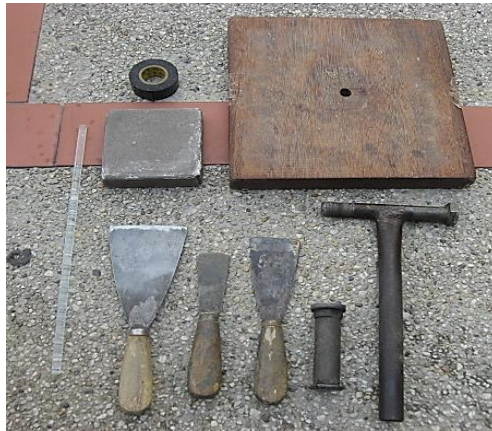
Figura 47. Herramientas utilizadas durante el proceso de vertimiento y compactación de la mezcla.
