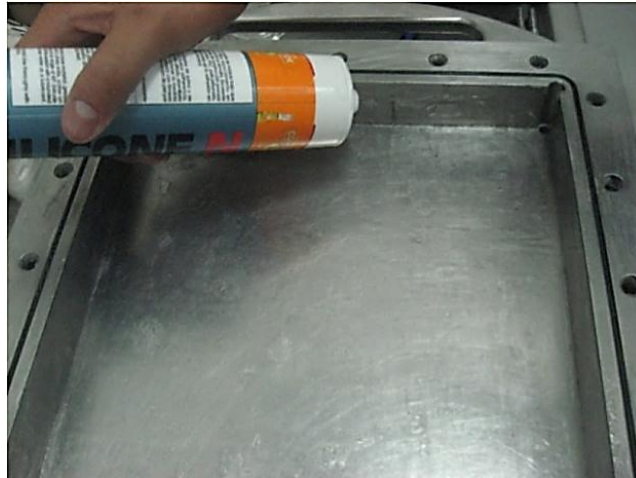
Figura 36. Distribución de la silicona en el modelo físico radial para el pegado del acetato.
