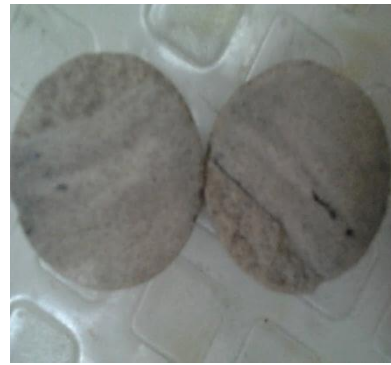
Figura 24. Plug sintético después de la prueba de desplazamiento con vapor.
