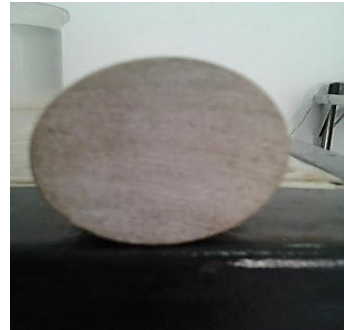
Figura 23. Plug sintético antes de la prueba de desplazamiento con vapor.
