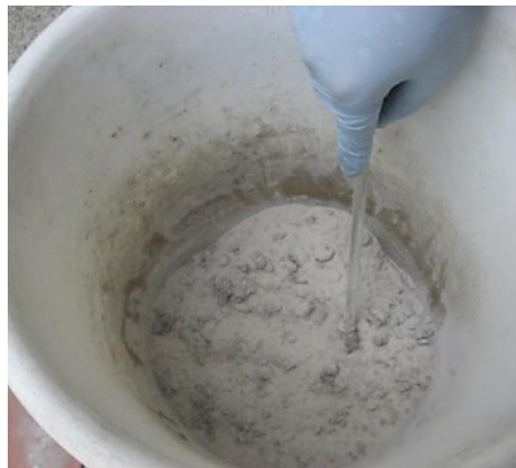
Figura 44. Mezclado inicial de la solución epoxica con la arena y el caolín.
