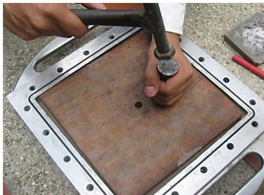
Figura 48. Compactación inicial de la mezcla utilizando el pisón grande.
