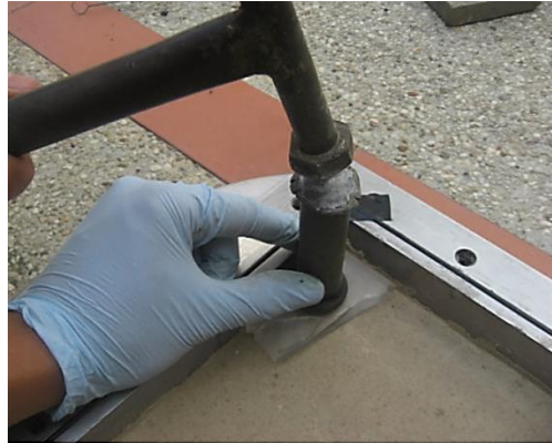
Figura 49. Compactación de los bordes del medio poroso.
