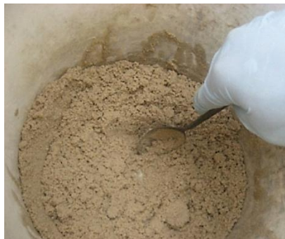
Figura 45. Mezclado inicial de la solución epoxica con la arena y el caolín.
