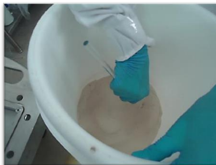
Figura 12. Mezcla en seco de la arena y el caolín - construcción de plugs sintéticos.
