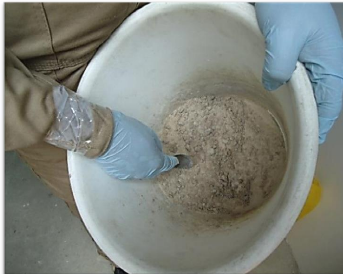
Figura 14. Mezcla de solución epóxica con la arena y el caolín - construcción de plugs sintéticos.
