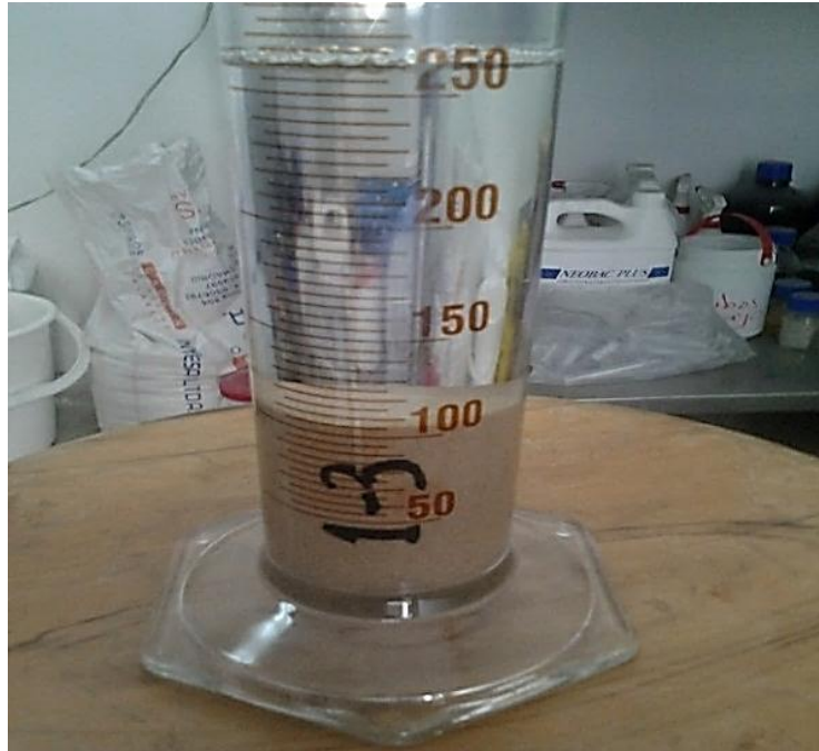
Figura 25. Plug 1-3 en imbibición natural.
