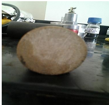
Figura 24. Plug sintético después de la prueba de desplazamiento con vapor.
