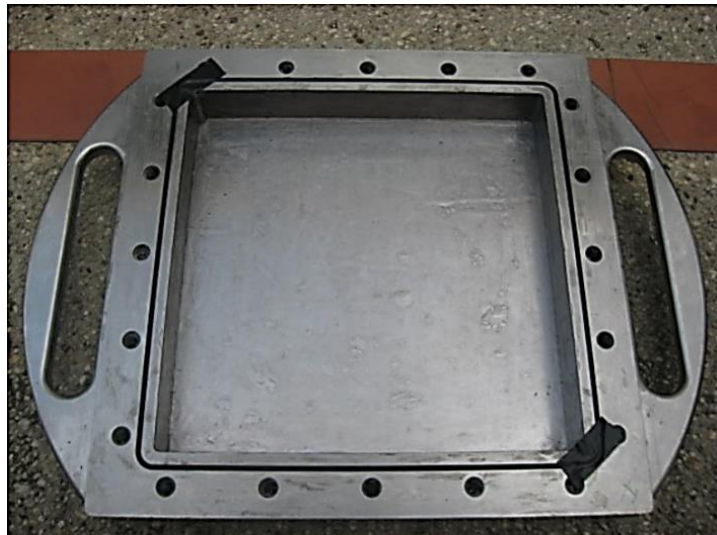
Figura 37. Porta medio poroso con los empaques de acetato.
