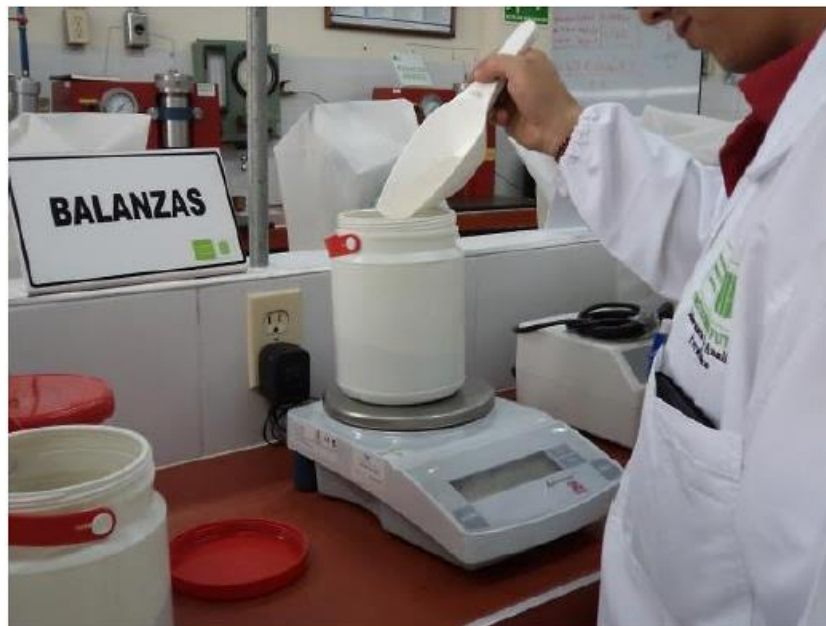
Figura 10. Balanza digital utilizada para la medición de la masa de arena y caolín blanco.
