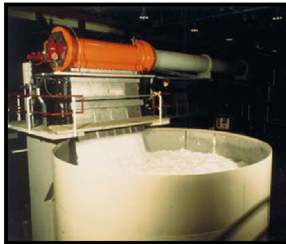
Figura 4.2. Tanque de pesaje recibiendo el agua que pasa a través del desviador de flujo.
