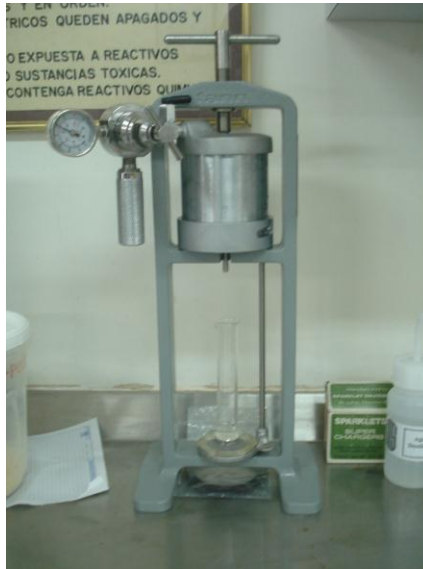
Figura 15: Filtro prensa utilizada para la filtración del lodo preparado
