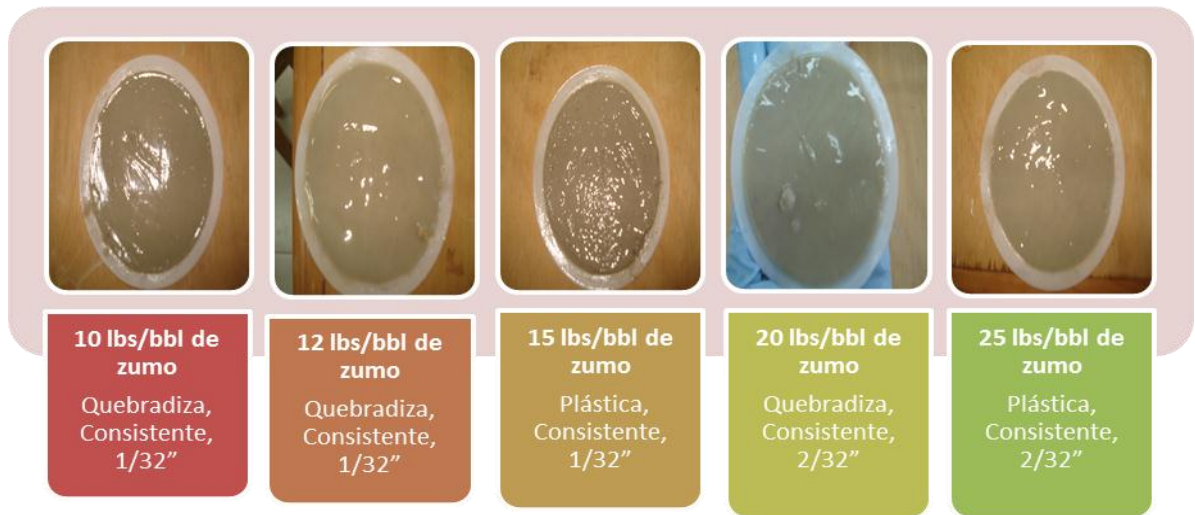
Figura 19: Tortas lodo base 3 (30 lbs/bbl de bentonita) + zumo de planta cadillo
