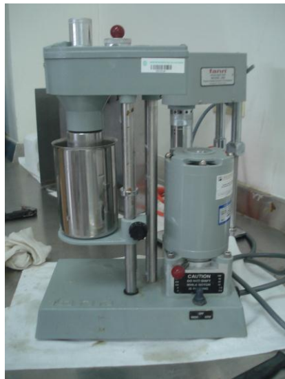
Figura 14: Viscosímetro fann utilizando para hallar los valores de \theta 600 y \theta 300
