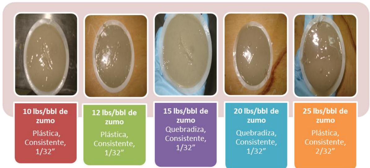
Figura 17: Tortas lodo base 1 (20 lbs/bbl de bentonita)+ zumo de planta cadillo
