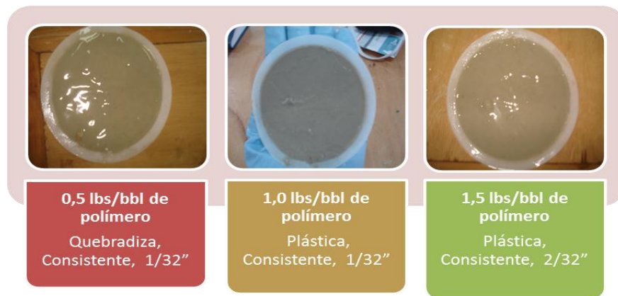
Figura 21: Tortas lodo base 2 (22 lbs/bbl de bentonita)+ XC polymer
