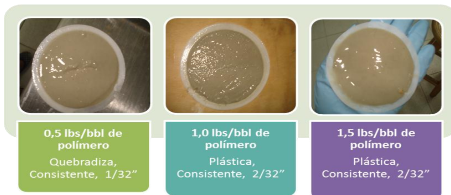
Figura 22: Tortas lodo base 3 (30 lbs/bbl de bentonita) + XC polymer
