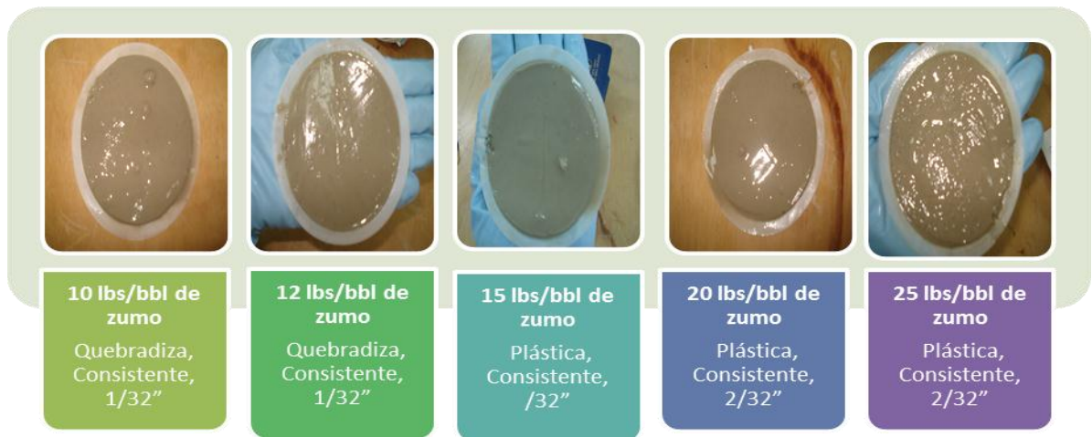
Figura 19: Tortas lodo base 3 (30 lbs/bbl de bentonita) + zumo de planta cadillo
