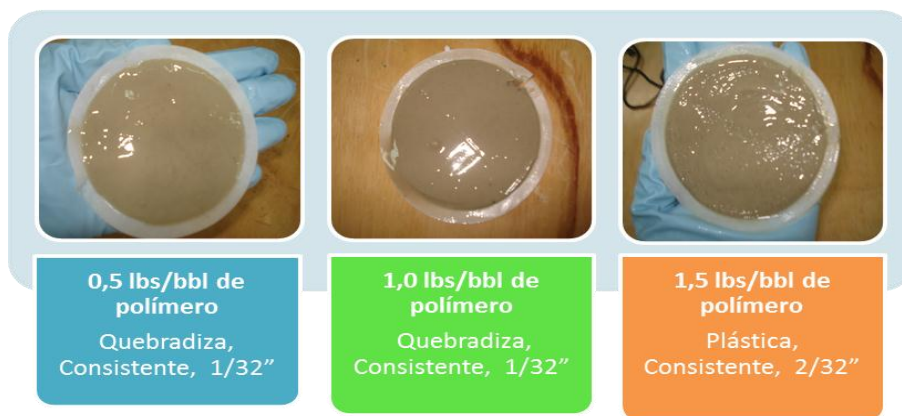
Figura 22: Tortas lodo base 3 (30 lbs/bbl de bentonita) + XC polymer
