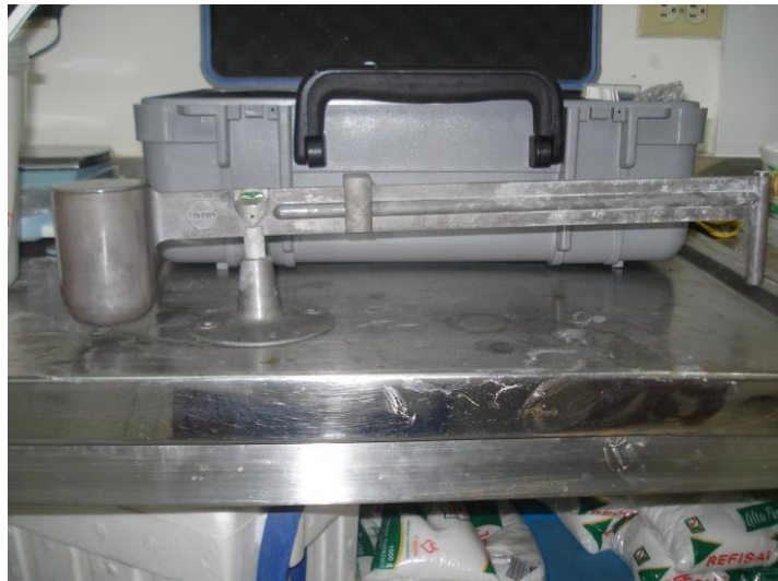
Figura 12: Balanza de lodo utilizada para determinar la densidad de los lodos preparados
