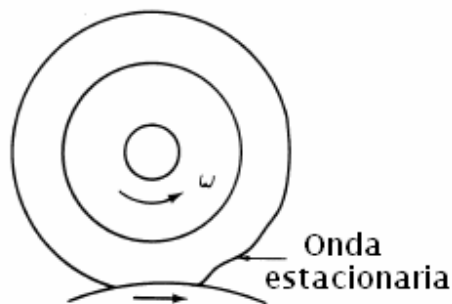
Figura 1.9 Formación de ondas estacionarias de la llanta a altas velocidades.
