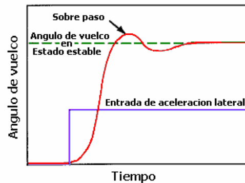
Figura 5.6 Respuesta de vuelco a una entrada escalón.
