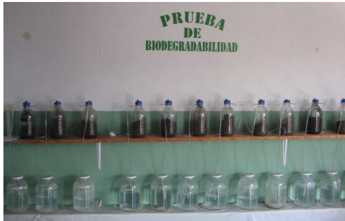
Figura 8. Batería de reactores para la realización de la prueba de biodegradación
