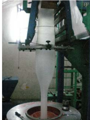
Figura 4. Extrusión de películas biodegradables
