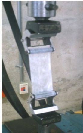
Figura 7. Montaje de muestras en mordazas para prueba de tensión.
