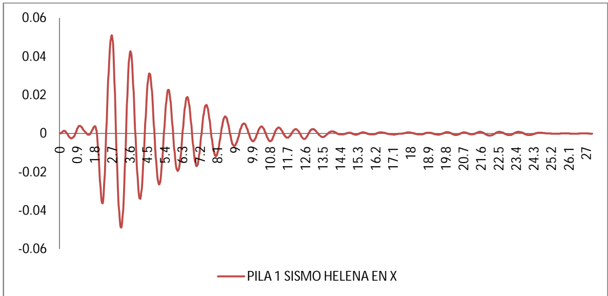
Ilustración 55: Deformaciones en el nodo de control pila 1 bajo la acción del sismo Helena aplicado en dirección x.
