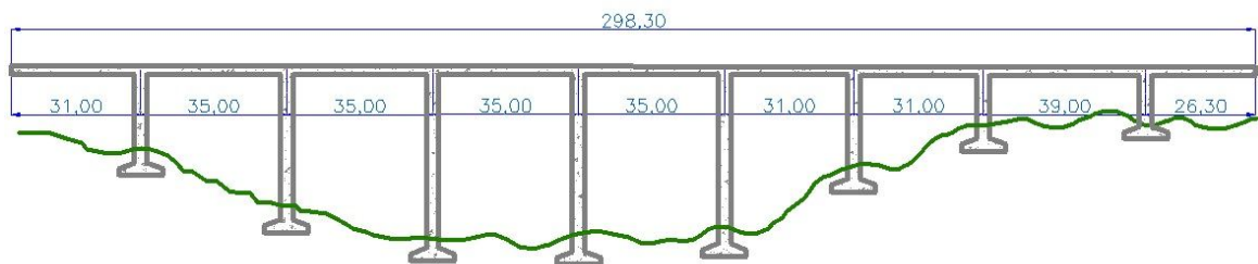
Ilustración 4: Dimensiones laterales del viaducto.
