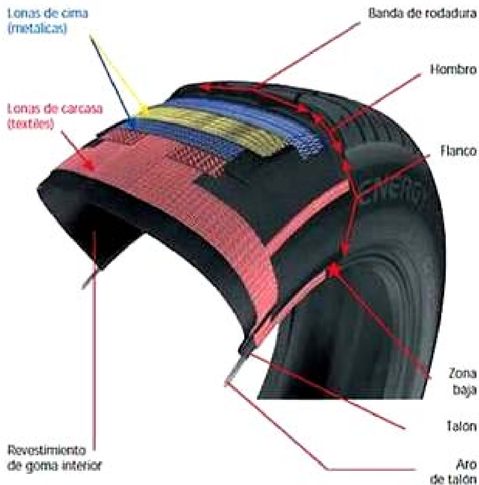
Figura 32. Estructura de una llanta radial. 107
