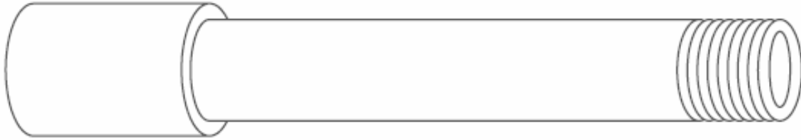
Figura 5.1 Tubo conduit metálico de pared gruesa (Tipo Pesado).
