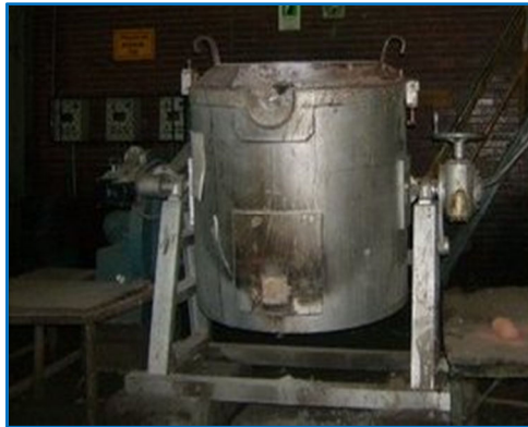
FIGURA 14. Horno basculante con crisol fijo. [19]
