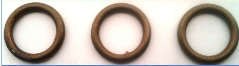
FIGURA 31. Arandela de latón a elaborar a partir del proceso de moldeo en molde metálico.
