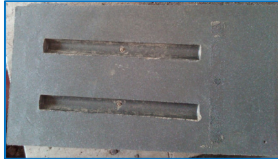
FIGURA 29. Moldes en arena usados para colar las aleaciones de prueba. (Caja inferior).
