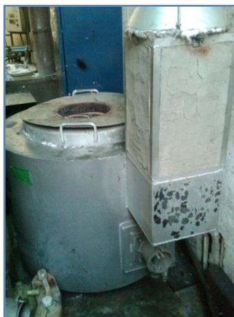
FIGURA 21. Horno de crisol fijo terminado en la empresa FANTAXIAS SAS.
