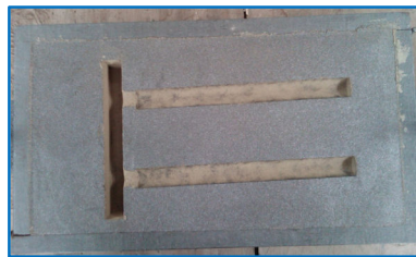
FIGURA 29. Moldes en arena usados para colar las aleaciones de prueba. (Caja inferior).
