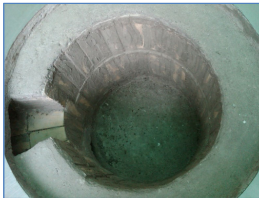
FIGURA 21. Horno de crisol fijo terminado en la empresa FANTAXIAS SAS.
