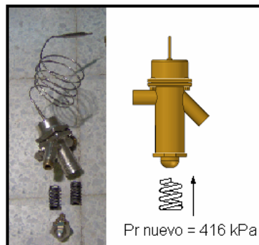
Figura 46. Cambio de resorte en la V.E.E.
