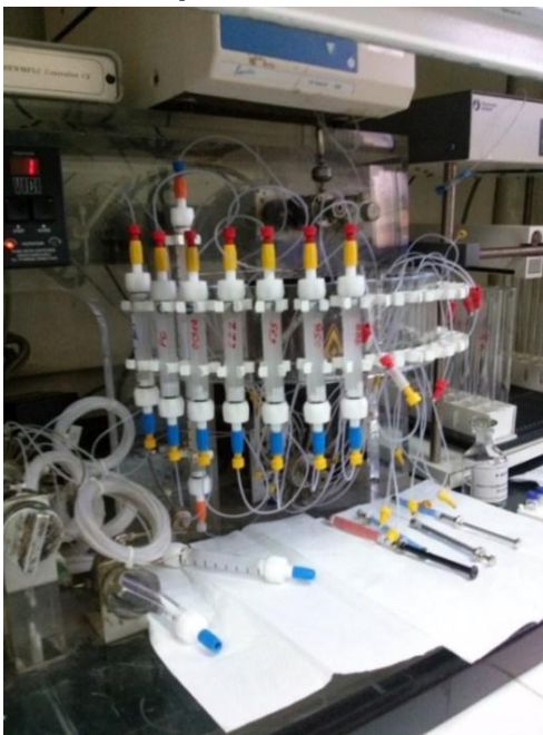
Figura 12. Montaje de cromatografía líquida con acoplamiento a detector UV y de Índice de Refracción usado para hacer el fraccionamiento SAR.
