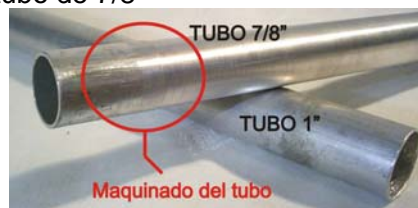
Figura 172. Maquinado del tubo de 7/8 "
