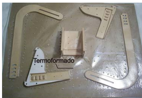
Figura 152. Termoformado de las piezas
