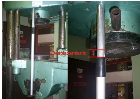
Figura 163. Prueba de compresión con tubos de aluminio y cilindros de caucho
