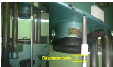
Figura 164. Prueba de compresión con tubo roscado y acople de rosca cónica
