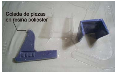
Figura 153. Colada de las piezas en el molde de termoformado.
