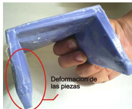
Figura 154. Fallas por pandeo de las piezas
