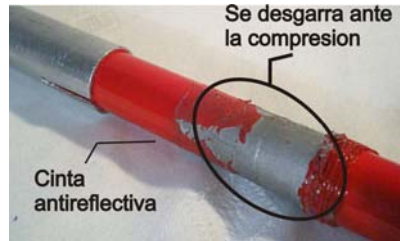
Figura 169. Prueba de compresión del tubo con una capa de cinta reflectiva
