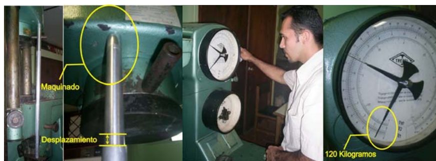
Figura 173. Prueba de compresión del tubo de 3/4 " maquinado.
