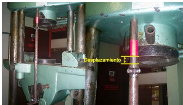
Figura 160. Prueba de compresión con tubos cold roll
