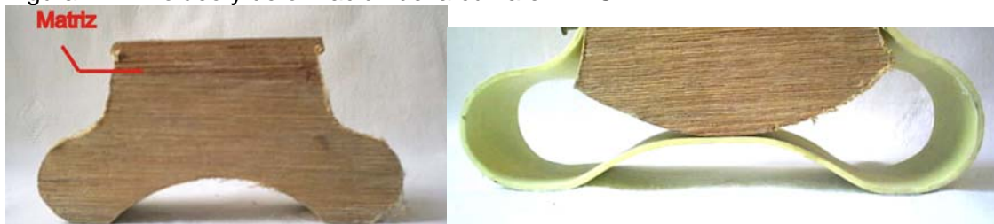
Figura 112. Moldeo y deformación de la curva en PVC
