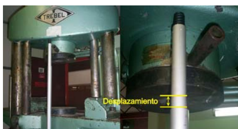
Figura 165. Prueba de compresión con acople de cuña interior
