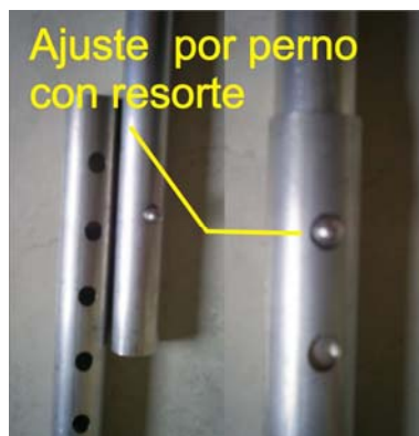
Figura 128. Sistema de ajuste agujero - perno con resorte
