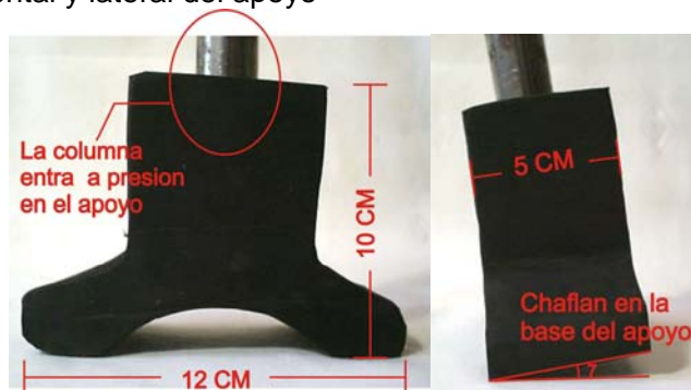
Figura 123. Vista frontal y lateral del apoyo
