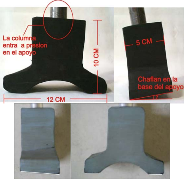
Figura 132. Vista frontal y lateral del apoyo
