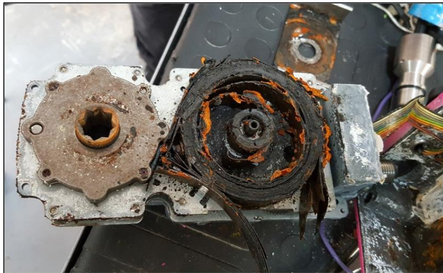
Figura 22. Revisión y estado de válvula ON/OFF
