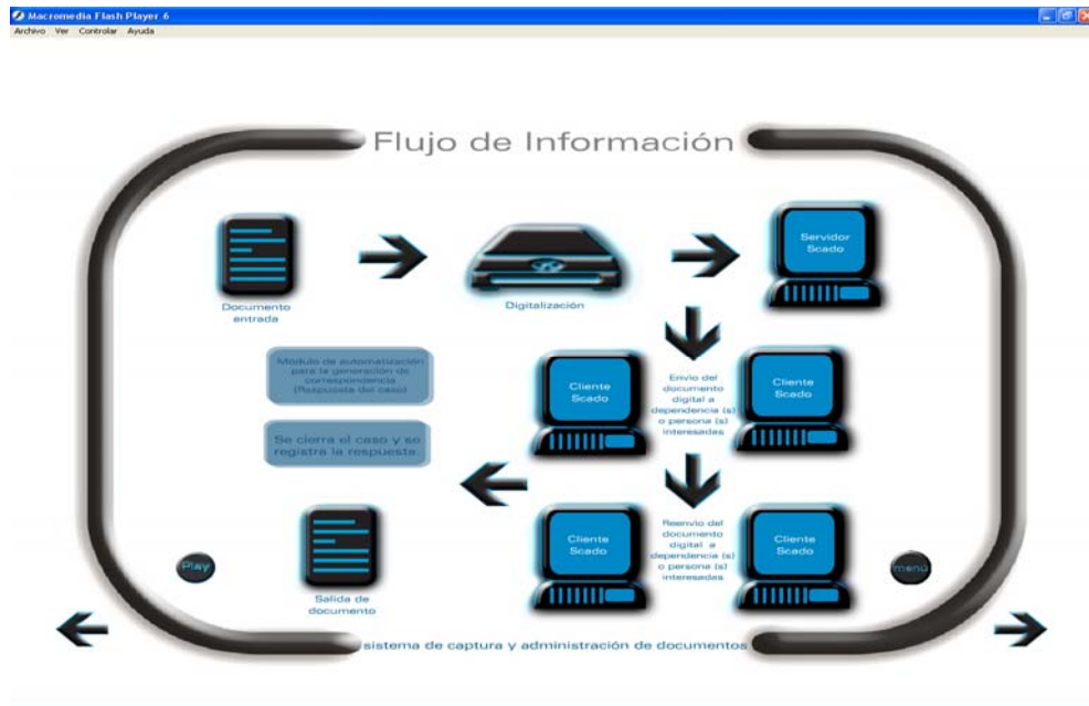
Figura 27 Sistema de flujo de información para SCADO
