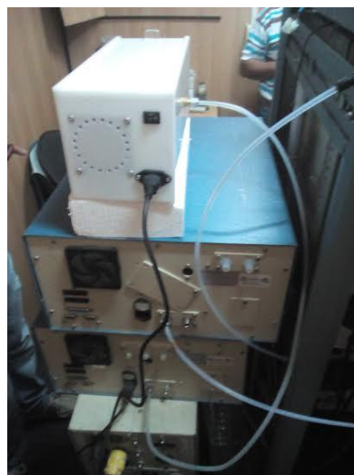
Figura 14. Acople entre el ozonizador y el analizador de ozono
