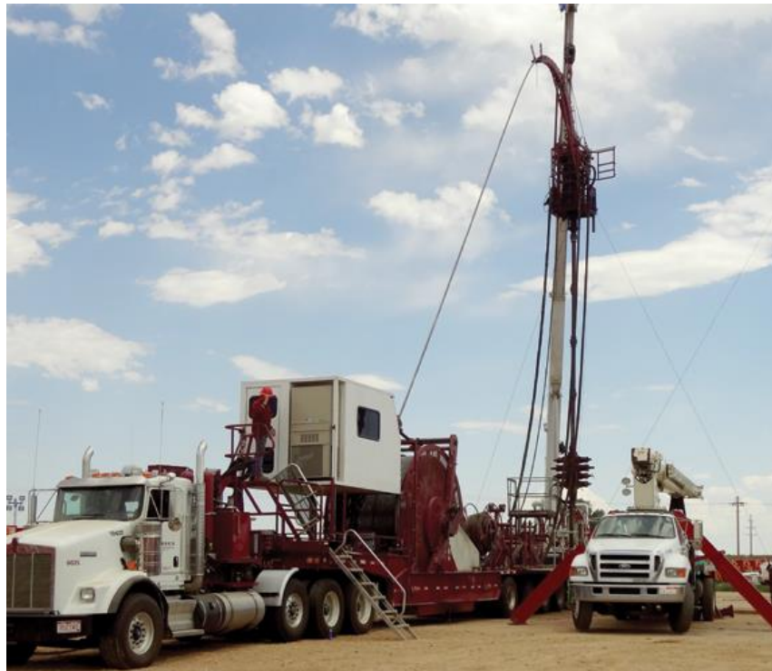
Figura 87. Unidad de CTD con la cabeza de inyección
