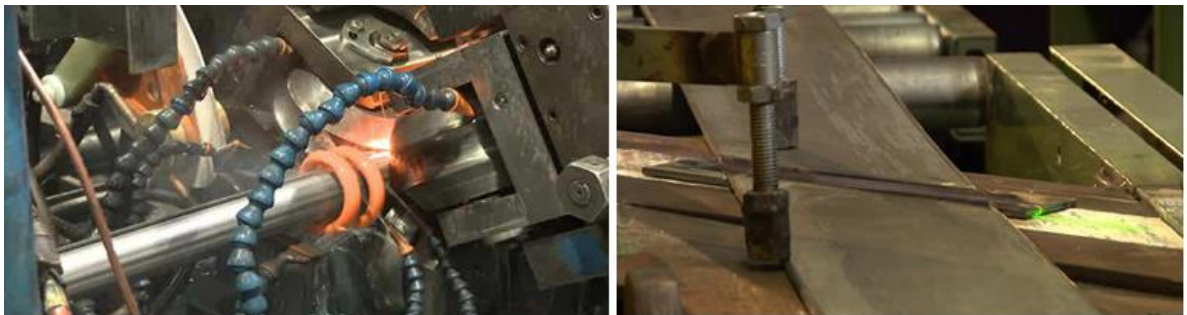
Figura 13. Soldadura longitudinal y de polarización
