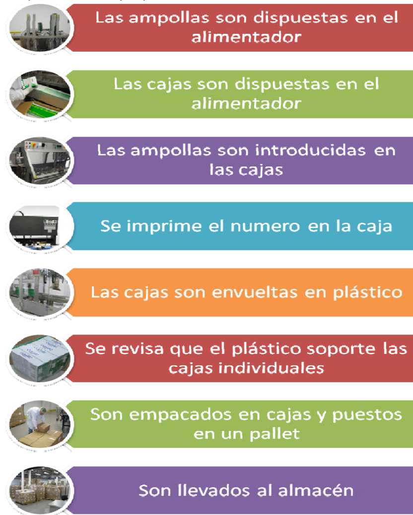
Figura 23. Esquema de empaque en la cartonera.
