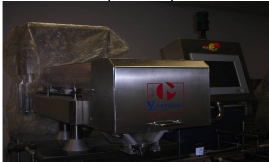
Figura 42. Máquina de suministro de pastillas por medio de canales.
