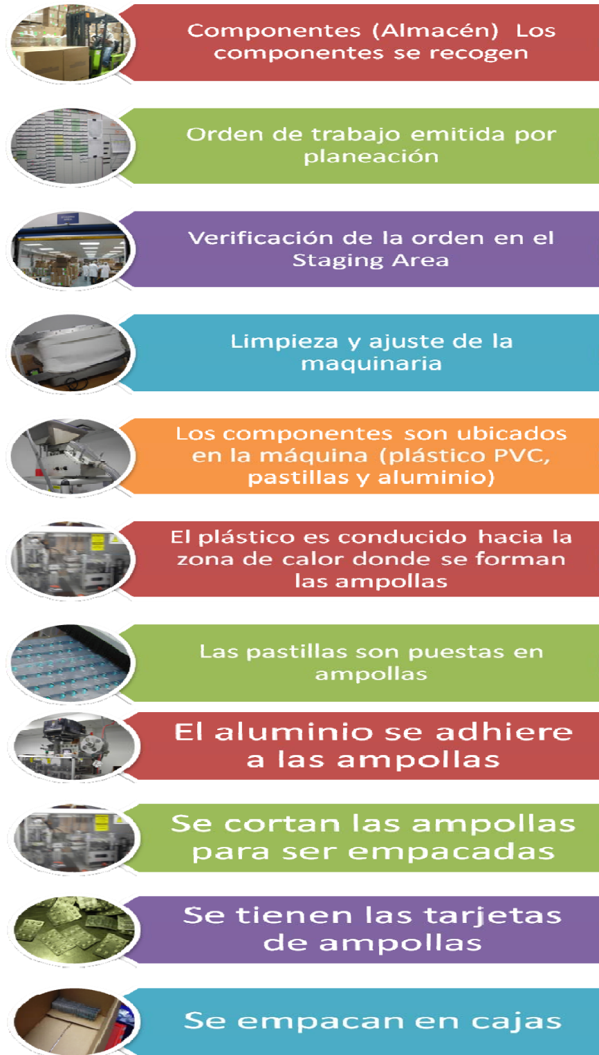
Figura 21. Esquema de empaque Ampollas.
