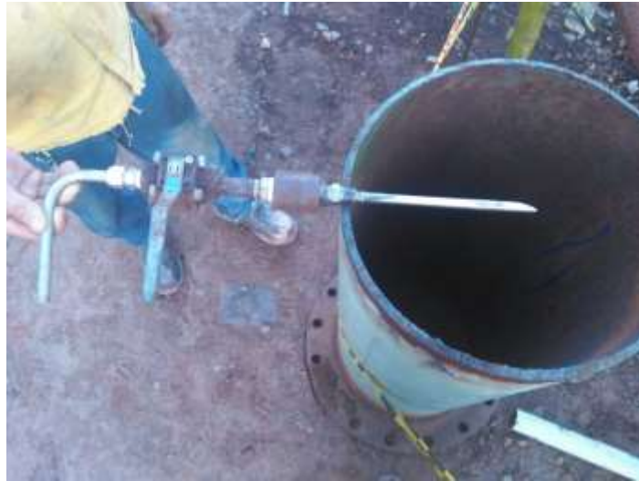
Ilustración 19: Toma muestras fabricado para Clúster A y B.
