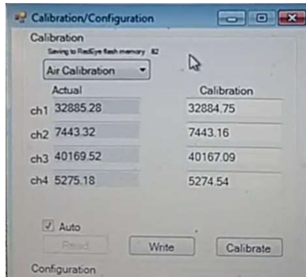
Ilustración 21: Procedimiento calibración punto 1 (Aire) - Software Red Eye.
