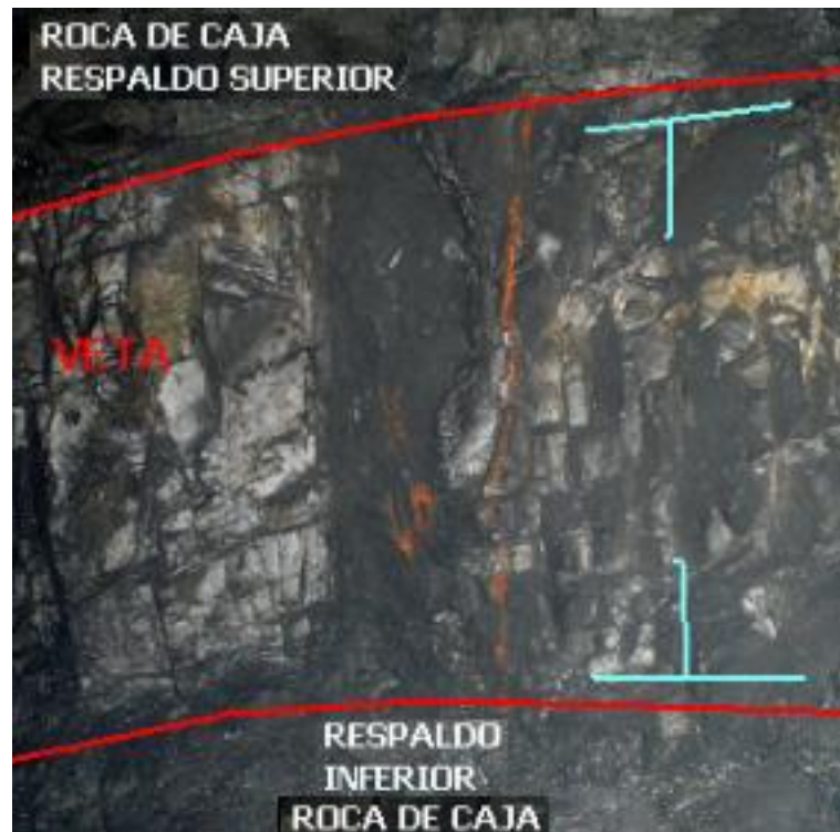
FIGURA 64. Método de muestreo aplicado tanto en tunelería como en frente de explotación. Muestreo de canal perpendicular al contacto con la roca caja. Tomado de Naranjo (2008).
