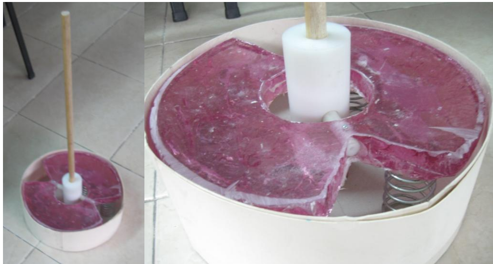
Figura 45. Modelo funcional de las plataformas rotativas de resorte.
