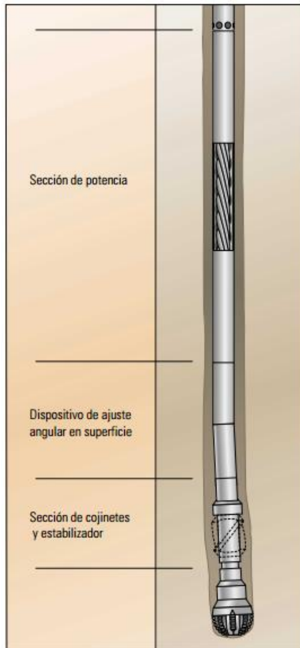
Figura 16. Representación de sarta de perforación con PDM en hueco abierto.
