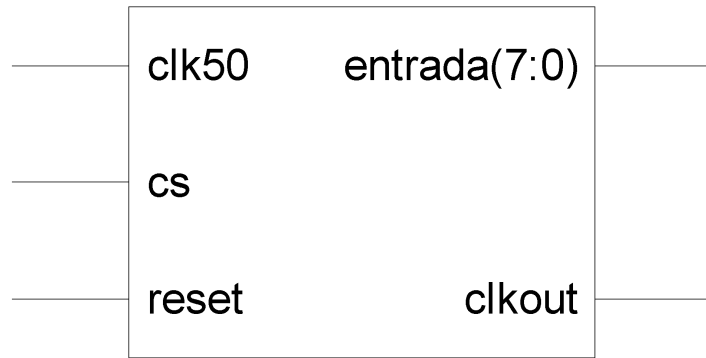
Figura 15. Diagrama de bloques de la tarjeta que contiene el PicoBlaze con la memoria.
