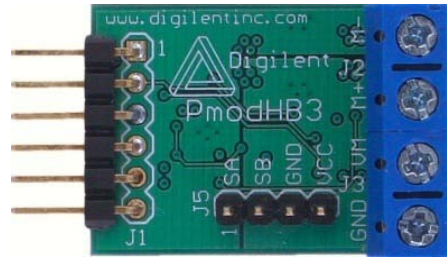
Figura 36. Módulo del puente H [37].
