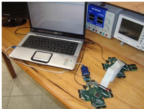
Figura 47. Implementación del ES del RS232.
