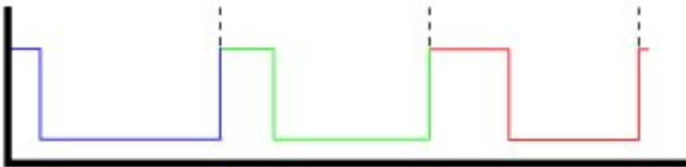
Figura 21. PWM para recorrer todo el rango de operación del servo [48].
