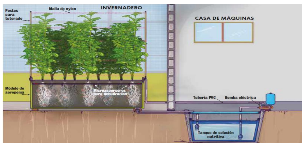
Figura 21. Sistema de riego para un cultivo aeropónico. Adaptado de CIP, INIAP, & CORPOICA. (2015). Manual para la Producción de Semilla de Papa usando Aeroponía. Retrieved from http://cipotato.org/wp-content/uploads/2014/08/005566.pdf .
