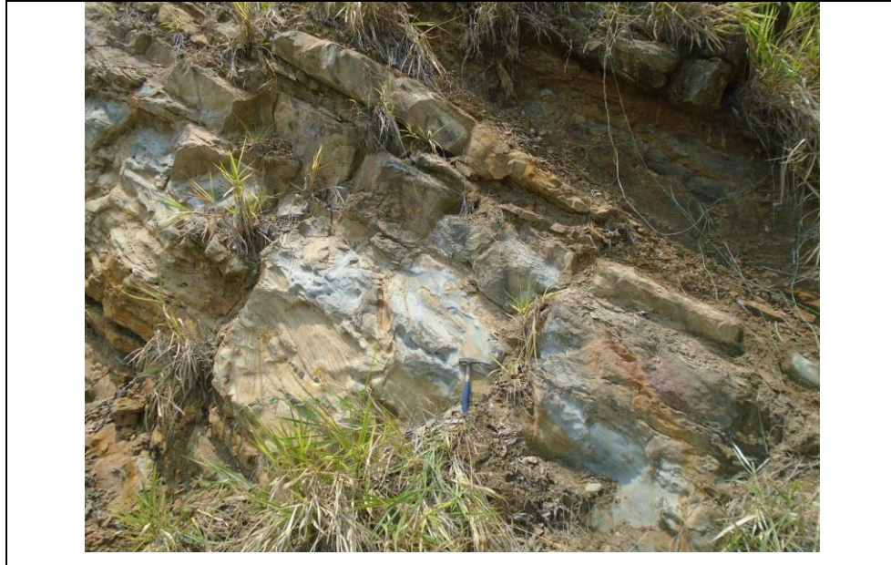
Fotografía 3. Intercalación de lutitas y rocas duras (R4) de areniscas de grano fino, moderada a poco fracturadas y grado meteorización W2.
