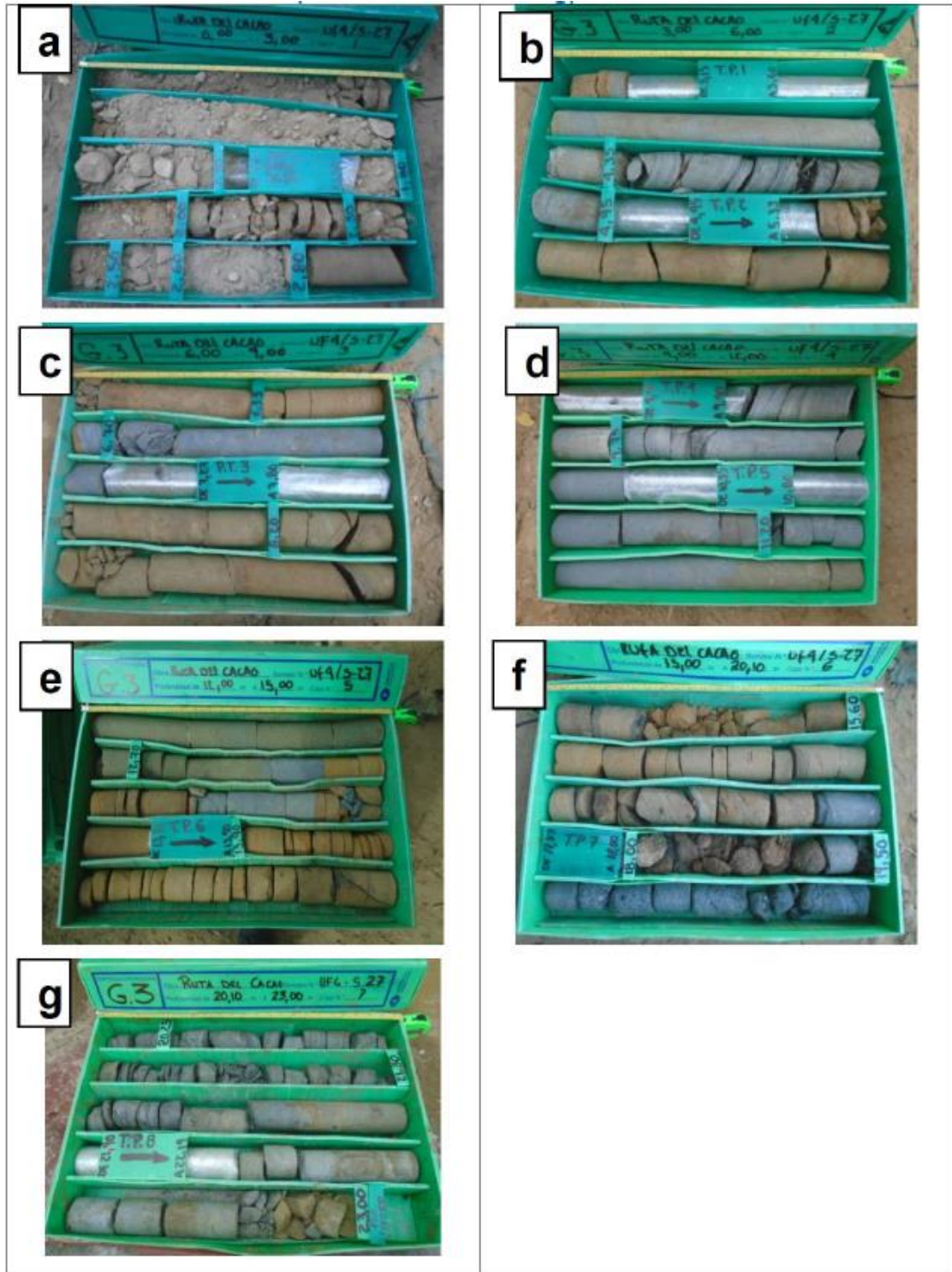
Fotografía 32. Fotos del sondeo F4-S27 con una profundidad de 23.00 m. a) 0.00 – 3.00 m. b) 3.00 m – 6.00 m. c) 6.00 m – 9.00 m. d) 9.00 m – 12.00 m. e) 12.00 m – 15.00 m. f) 15.00 m – 20.10 m. g) 20.10 m – 23.00 m.
