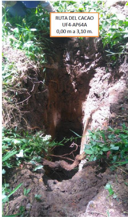
FOTO 1 - ASPECTO GLOBAL DEL APIQUE.
