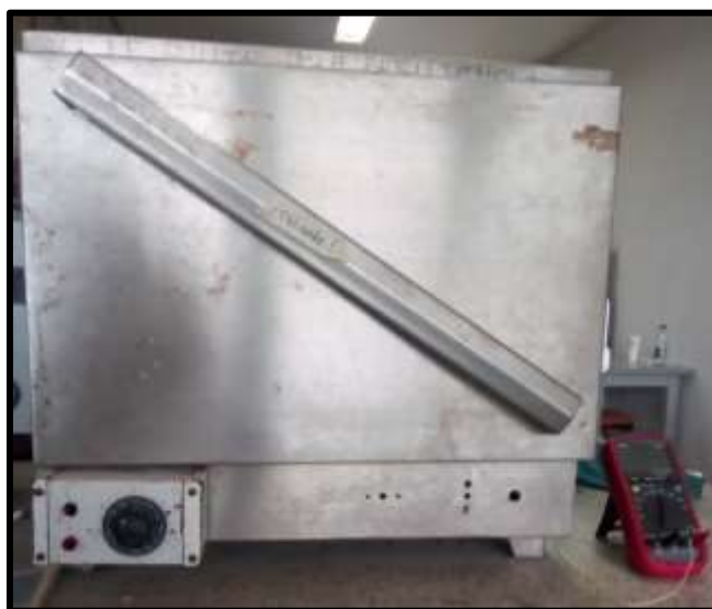
Figura 13. Estufa de convección y multímetro con termocupla
