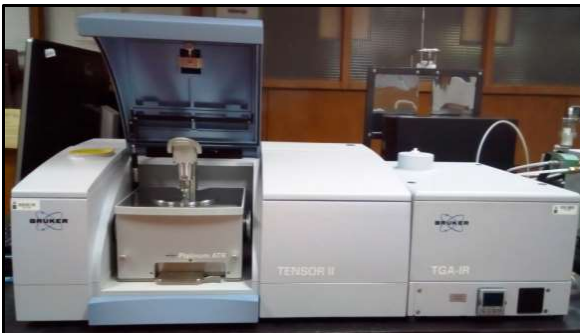
Figura 8. Espectrofotómetro de infrarrojo BRUKER TENSOR II acoplado a accesorio de reflectancia total atenuada ATR Platinum ATR
