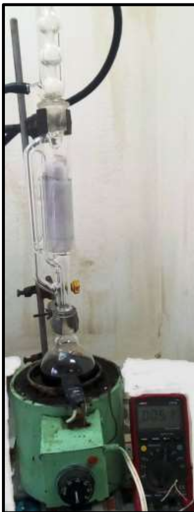
Figura 11. Extractor Soxhlet Convencional con muestra de Papel térmico
