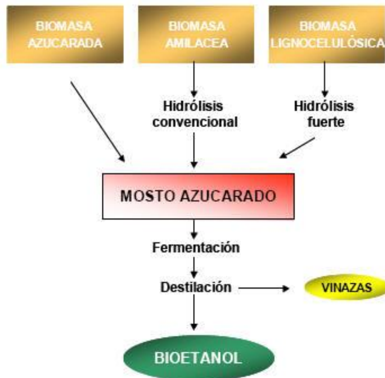
Figura 3. Proceso de obtención del bioetanol
