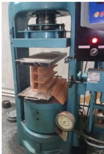
El procedimiento para la realización del ensayo, se basó en los parámetros expuestos por la norma NTC 4017 [Citado en 48] y los resultados para bloques H10 se exponen en la Tabla 8.
