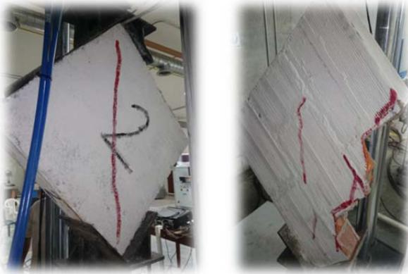
Los ensayos se realizaron tanto con muros frisados como sin frisar, para evaluar el aporte del mismo en la capacidad de los muretes. Para el caso de muretes con bloques H10, las curvas obtenidas se aprecian en la Figura 45. Una falla típica de los muretes por tensión diagonal puede observarse en la Figura 44.
