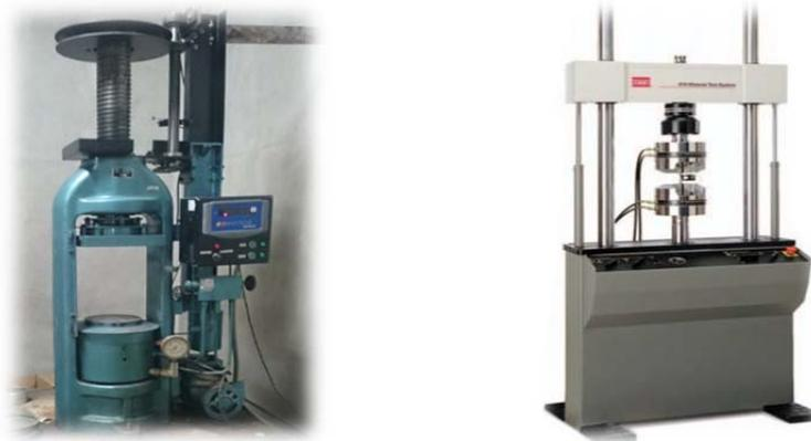
El ensayo de compresión axial se realizó con carga controlada, a una velocidad de 0,025 mm/sg. Las cargas fueron aplicadas hasta provocar la rotura de las pilas, instante donde se registró la carga máxima que puede soportar la pila de mampostería.
