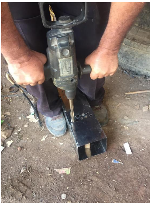
Figura 35. Taladrado para hacer los orificios.
