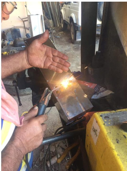
Figura 37. Soldadura para los adaptadores de las resistencias.
