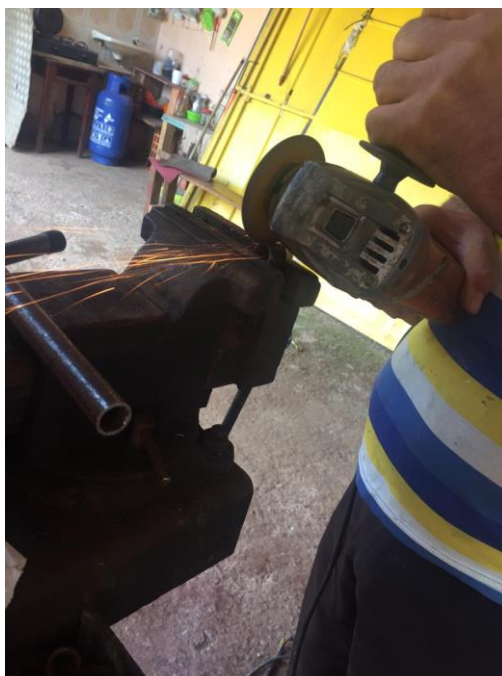
Figura 36. Construcción de adaptadores para las resistencias.
