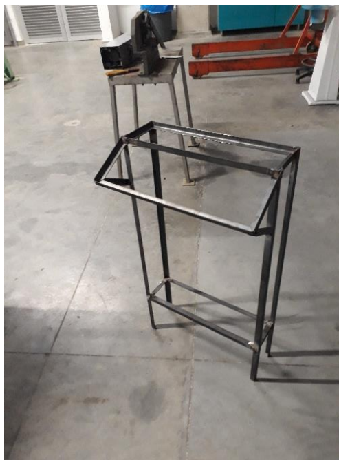
Figura 44. Estructura túnel de secado.
