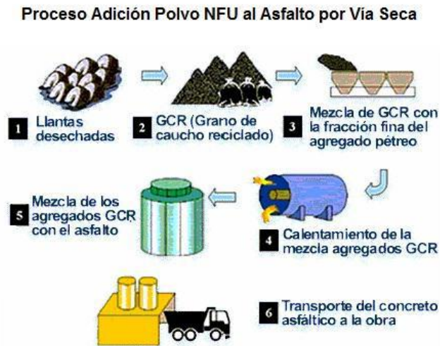
Figura 2 Proceso de fabricación de mezclas de concreto asfaltico con adición de caucho por via seca
