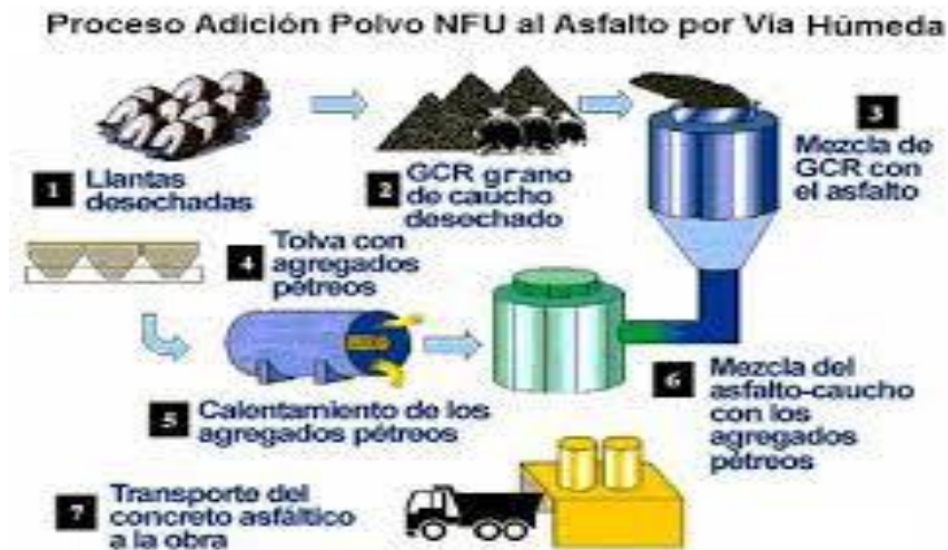
Figura 3. Proceso de fabricación de asfalto por la vía húmeda
