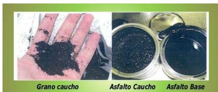
Figura 1. Presentación de la mezcla asfáltica
