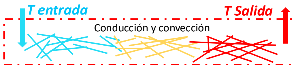
Figura 9 Transferencia de calor en un sistema fracturado EGS
