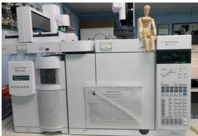
**Figura 13.** Cromatógrafo de gases GC *Agilent Technologies 7890 Series* (AT, Palo Alto, California, EE.UU.). Fotografía tomada por autora el 1 de agosto de 2016. Lugar, CROMMASS-UIS, Bucaramanga, Colombia.
