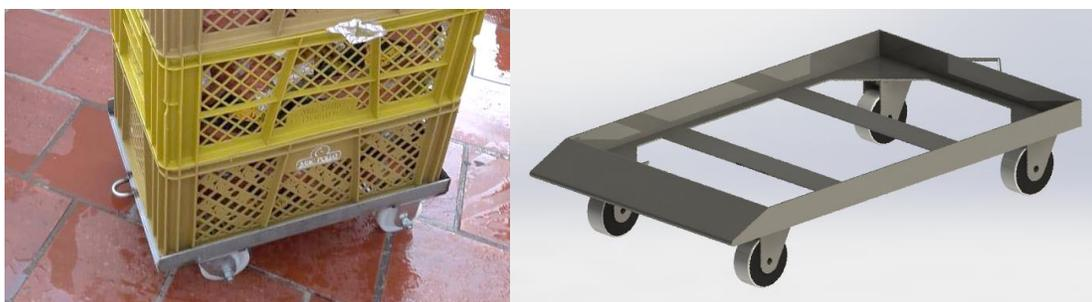
**Figura 24.** Carro 1 llevando una pila de canastillas y modelado 3D carro actual
