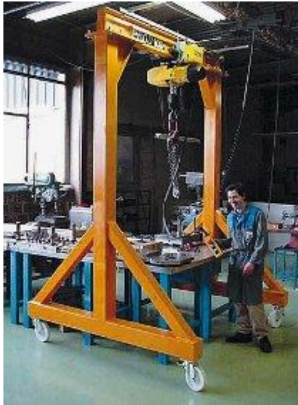
Figura 25. Subsistema puente grúa.
