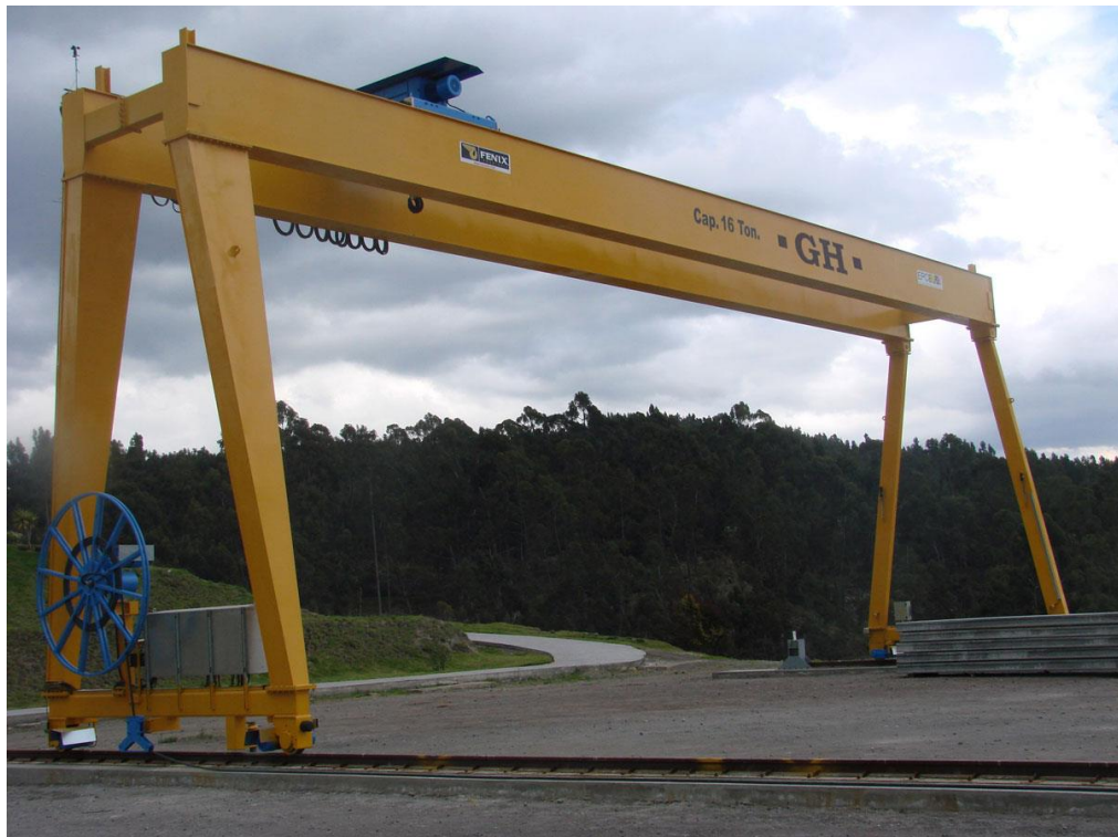
Figura 11. Grúa pórtico de 16 [t] apoyada sobre rieles
