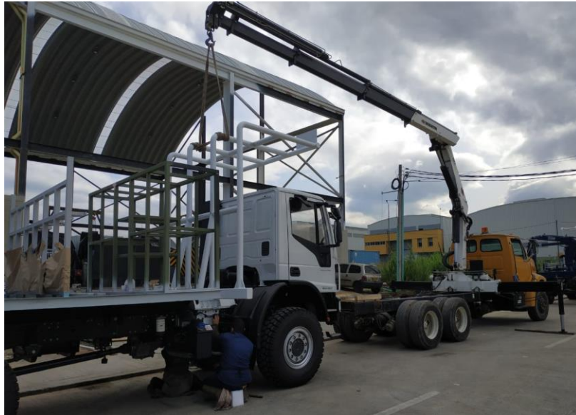
Figura 6. Elevación de barras antivuelco.
