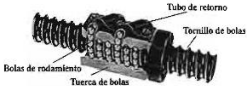
Figura 13. Tornillo de bolas y sus partes.
