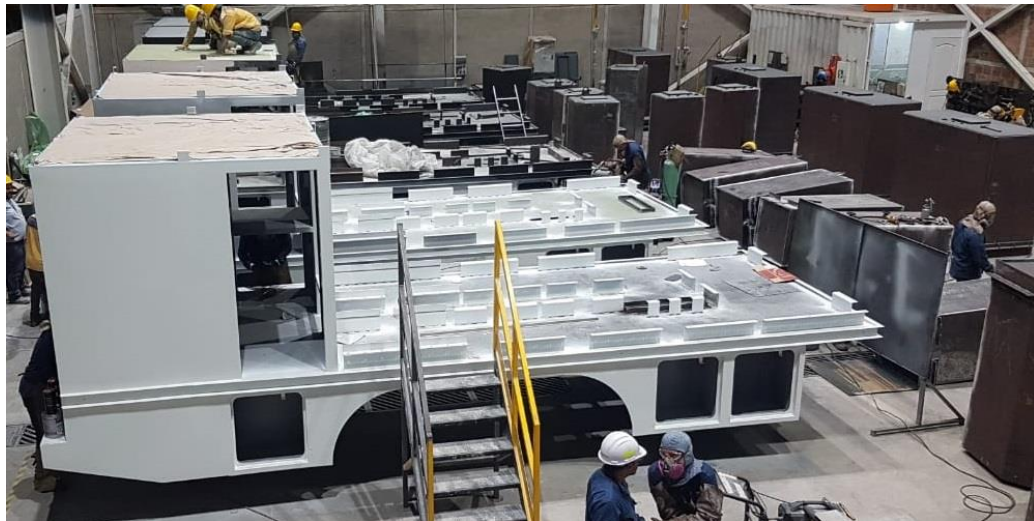
Figura 2. Carrocerías en fabricación.
