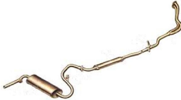
Figura 3. Sistema de escape de gases
