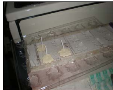
Figura 15. Proceso de producción Choco Ángel: Moldeado e introducción de pajilla
