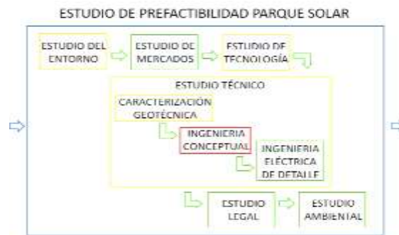
Figura 1. Diagrama de bloques del estudio de pre factibilidad del parque solar.
