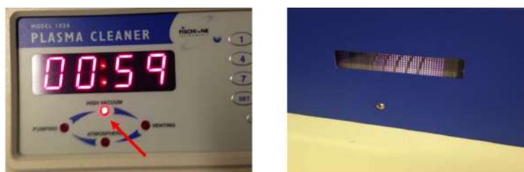
Figura F.12: Cuando el limpiador de plasma termine de bombear, se encenderá la luz indicadora LED de ALTO VACÍO y se encenderá una luz de plasma violeta en la ventana.
