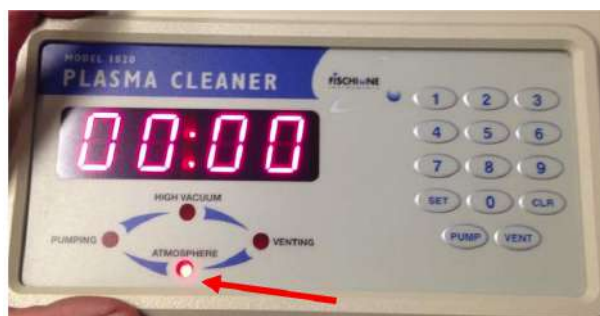
Figura F.4: Cuando esté activa, la atmósfera, la luz indicadora LED se encenderá.
