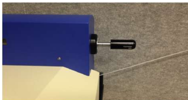
Figura F.9: Empuja la varilla hasta que se detenga.
