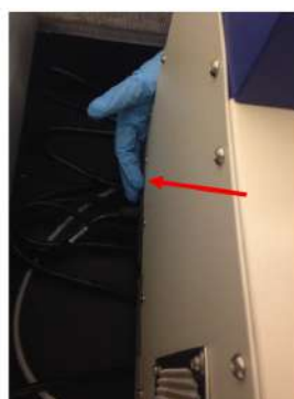
Figura F.3: Encienda el interruptor ubicado en la parte posterior de la máquina en el lado inferior derecho junto al cable de alimentación.
