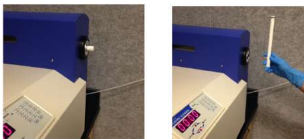
Figura F.5: Use los guantes y retire el porta-muestra.
