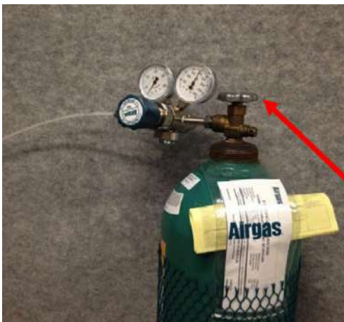
Figura F.1: Abra la válvula reguladora.
