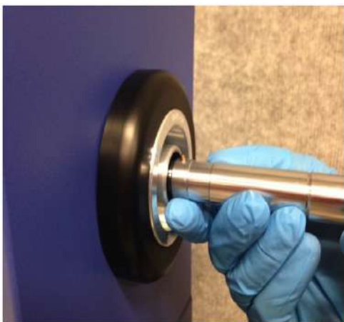
Figura F.7: Cargue la muestra de TEM en el limpiador de plasma.
