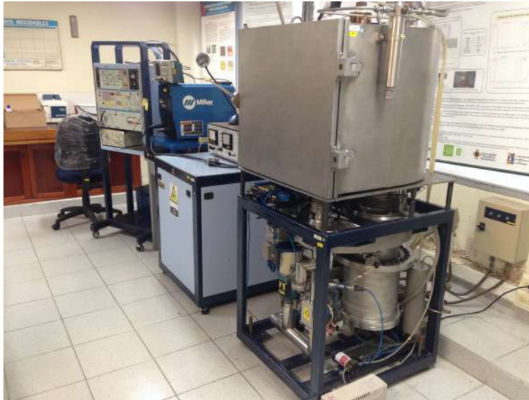
Figura 1.7: Equipo experimental empleado para los procesos de descargas pulsadas de alto voltaje y arco eléctrico en las instalaciones del laboratorio de física y tecnología del plasma de la Universidad Industrial de Santander.
