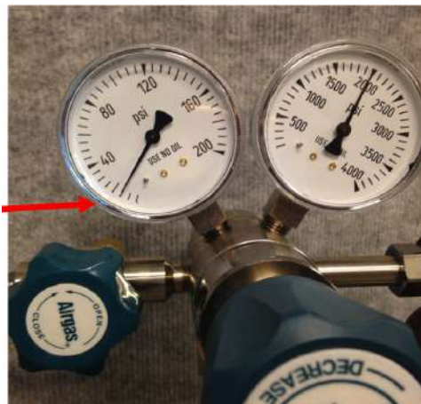
Figura F.2: El manómetro izquierdo debe mostrar 15 PSI.
