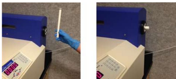
Figura F.15: Introduzca nuevamente el porta-muestra.
