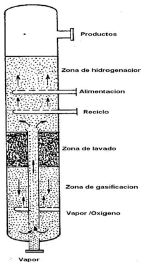
Fuente: Posibilidad técnica para la conversión de fracciones pesadas de un crudo en fracciones ligeras. A Treviño.
