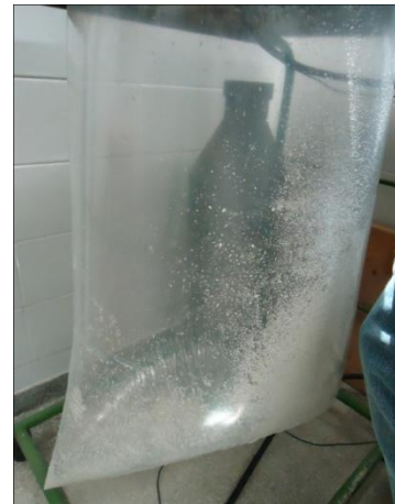
Figura 23. Alimentación del molino de impacto y material pulverizado
