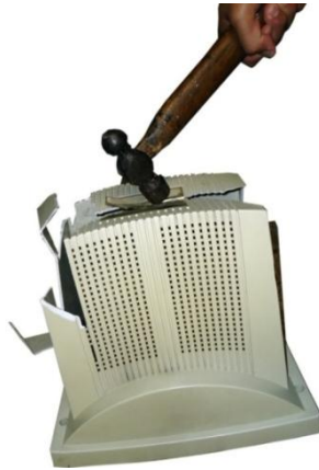
Figura 19. Carcasa quebrada con martillo
