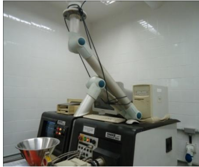
Figura 27. Detalle extractor de gases máquina extrusora
