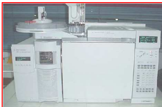
Figura 17. Cromatógrafo de gases de alta resolución Agilent Technologies 6890N Plus , con detector selectivo de masas Agilent Technologies MSD 5975 Inert XL .
