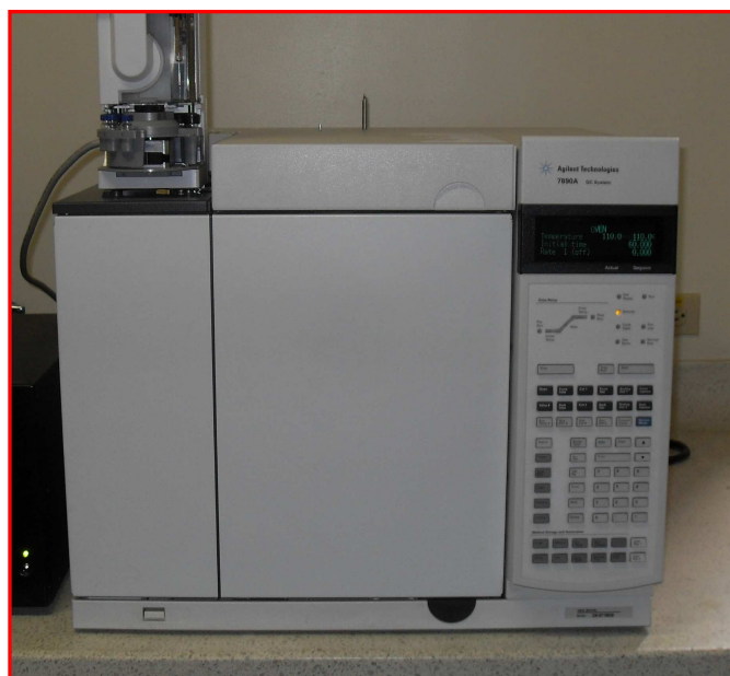
Figura 18. Cromatógrafo de gases de alta resolución Agilent Technologies 7890A, con detector de ionización en llama FID.
