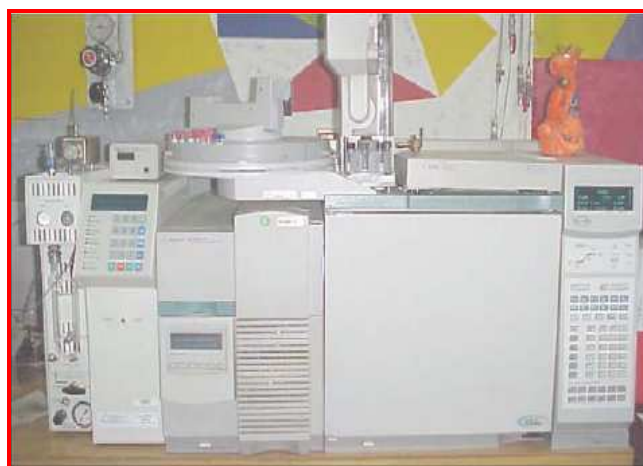
Figura 16. Cromatógrafo de gases de alta resolución Agilent Technologies 6890 Plus , con detector selectivo de masas Agilent Technologies MSD 5973 .
