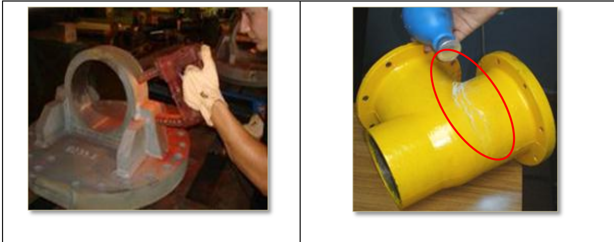
Figura 11. Componentes metalicos ferrosos inspeccionados por medio de la tecnica de Partículas Magnéticas.
