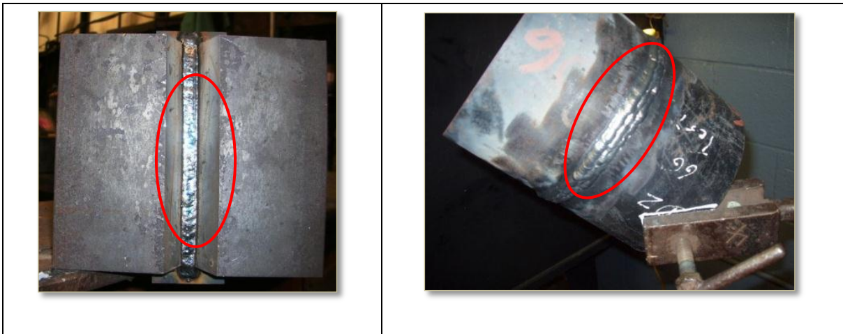
Figura 9. Cordones de soldadura inspeccionados por medio de la técnica Inspección Visual.
