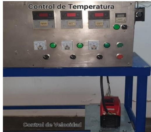
*Nota.* En la figura se presenta los controles térmicos y de velocidad de la maquina extrusora utilizada.
