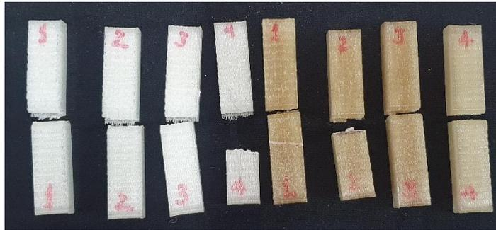
*Nota.* Fotografía probetas de impacto fracturadas de PLA puro y de PLA con refuerzo de hueso al 40%.
