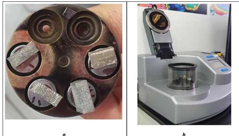
*Nota.* Fotografía laboratorio de microscopía a) muestras estudiadas en el respectivo stubs b) máquina de recubrimiento de las muestras.
