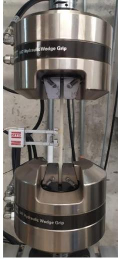
*Nota.* Fotografía de maquina universal de la escuela de Ingeniería Mecánica de la UIS, con el montaje de probeta y extensómetro.
