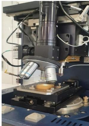
*Nota.* Fotografía de la máquina de indentación de Ingeniería Mecánica de la UIS.
