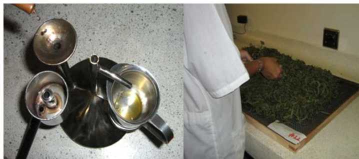
Figura 23 Destilador semi-industrial de cobre, para obtención de los AE.
