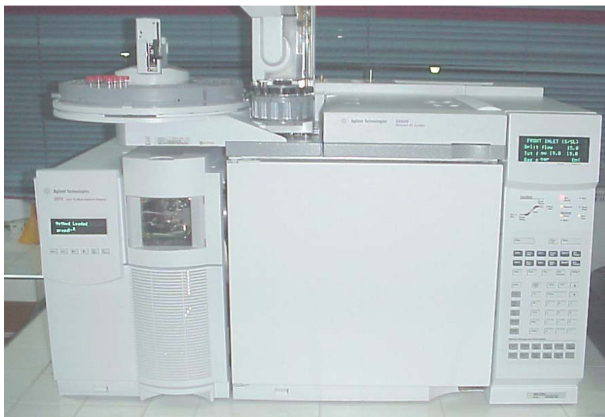
Figura 26 Cromatógrafo de gases (6890N), acoplado a espectrómetro de masas (5975) Agilent Technologies , usado para el análisis de los aceites esenciales.
