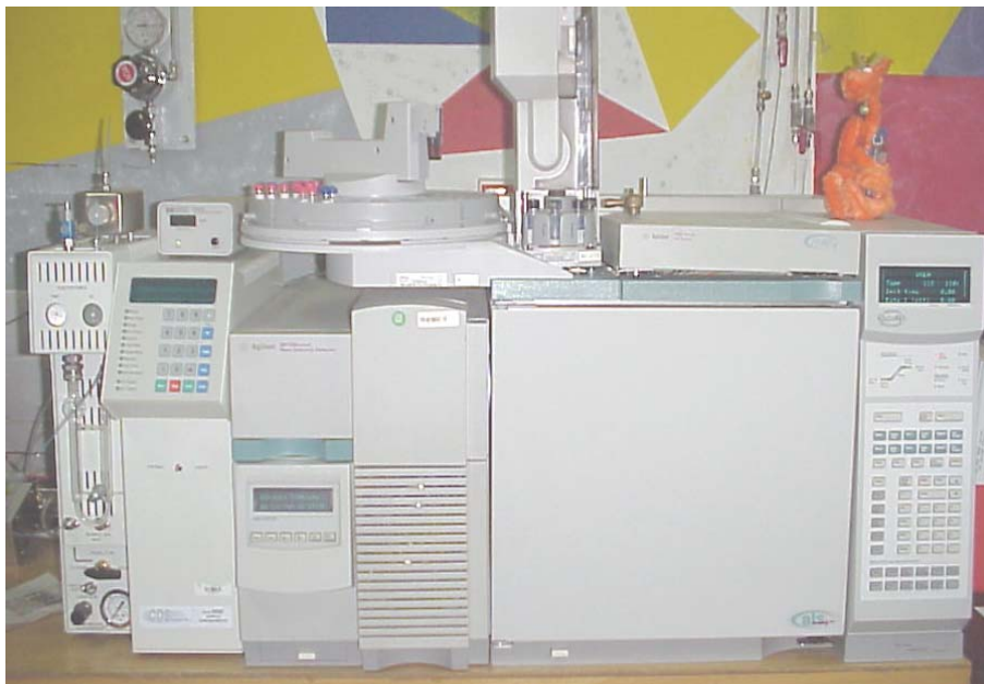
Figura 25. Cromatógrafo de gases (6890N), acoplado a espectrómetro de masas (5973) Agilent Technologies , usado para el análisis de los aceites esenciales.
