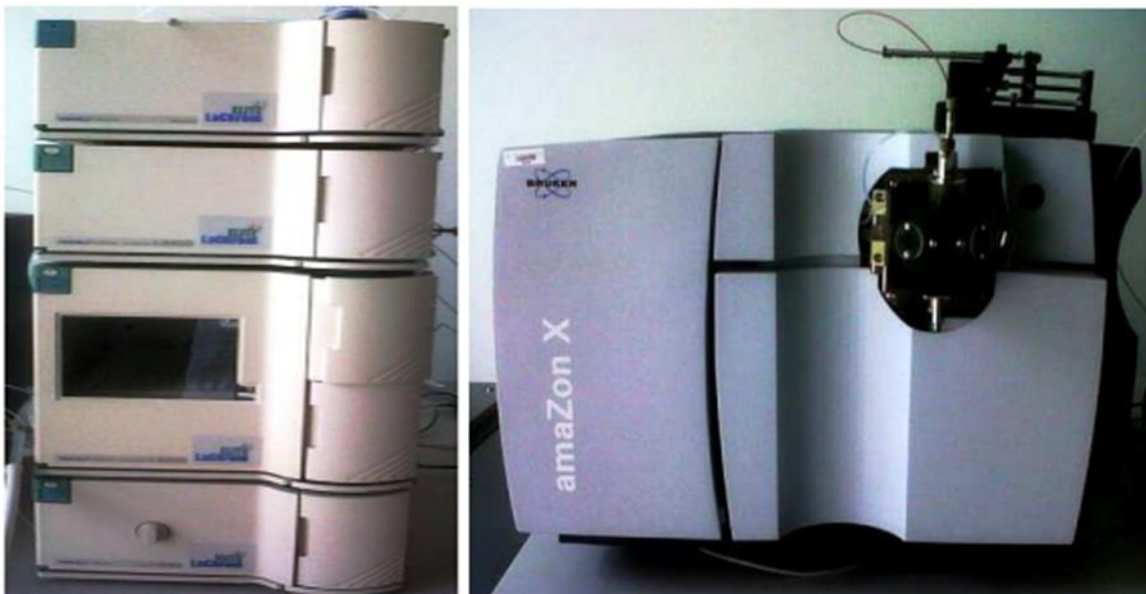
Figura 10. Vista general de un equipo de HPLC acoplado a un espectrómetro de masas. Fuente: Lab Espectrometría de Masas. UIS-Guatemala
