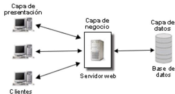
Figura 1. Arquitectura de tres capas
