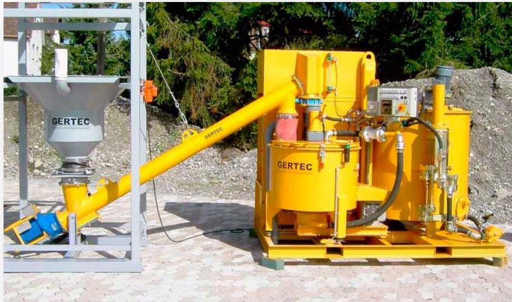
Imagen 3. Equipo de inyección de lechada.
