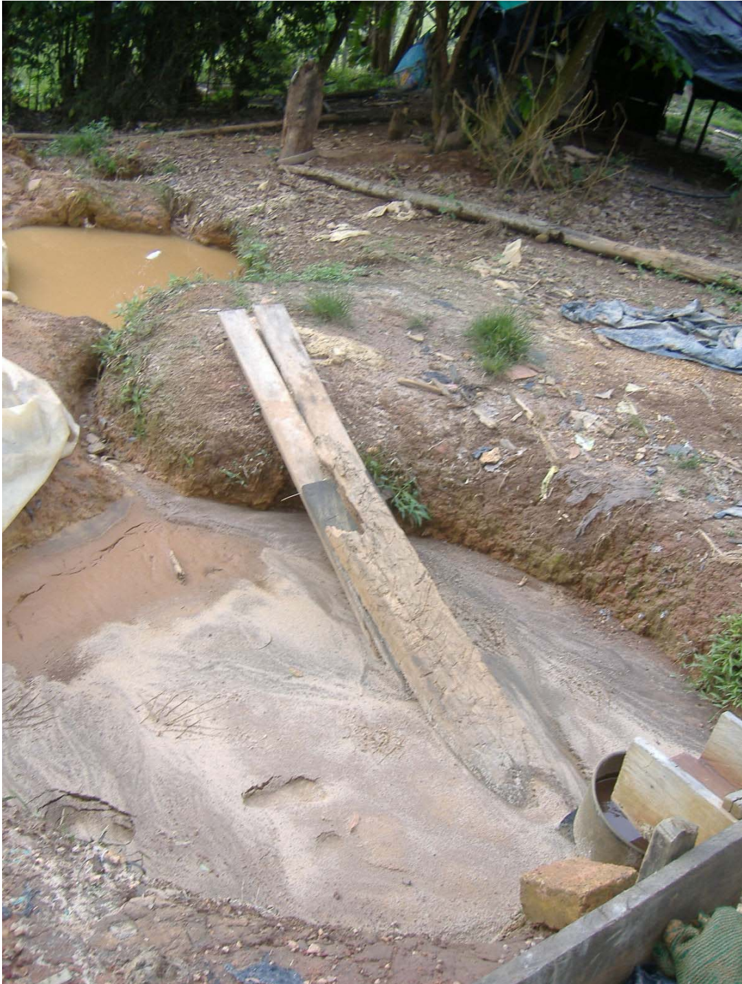
Foto 3. Arenas resultantes del proceso de amalgamación
