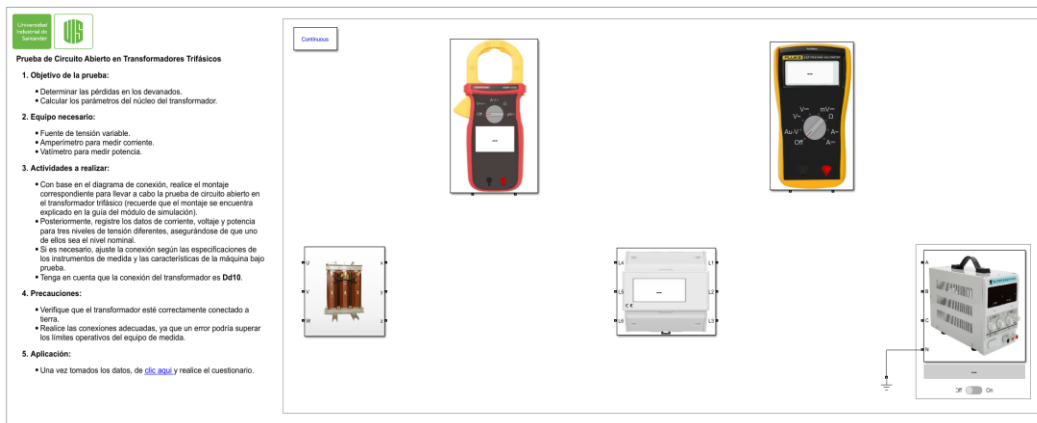
Figura 36. Práctica de circuito abierto en transformadores trifásicos
