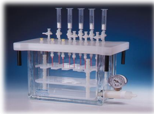
Figura 6. Equipo para extracción en fase sólida, Baker Spe-24G (J.T. Baker, Phillipsburg, NJ, EE.UU)
