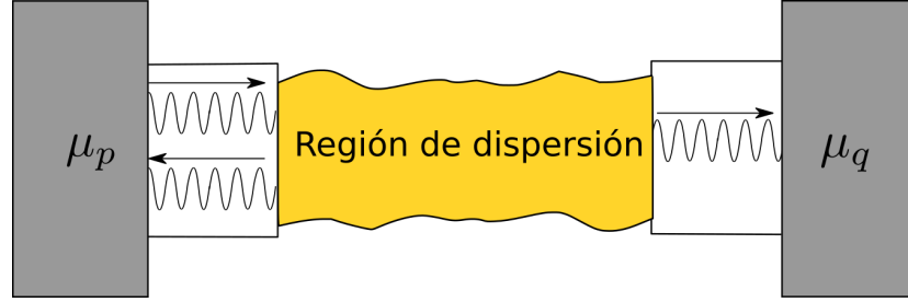
Figura 5. Representación esquemática de la configuración típica para el formalismo de Landauer-Buttiker. Dos grandes depósitos con potenciales químicos \mu_p y \mu_q , están conectados a través de contactos cuasi-unidimensionales a un dispositivo o región de dispersión con coeficiente de transmisión T(E) .
